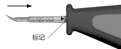
注意: 将烙铁头插入到标记处以确保正确连接。
