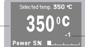
"Temp. Anpass" Parameter. Sorgt für eine präzise Anpassung zwischen der ausgewählten Temperatur und der derzeitigen.
