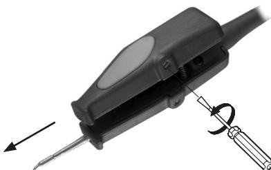
Die Schraube lockern und die Kartusche herausnehmen. **⚠️** Falls noch heiß, eine Flachzange verwenden.
