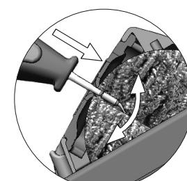
Falls die Spitze stark verschmutzt sein sollte, wird empfohlen, mit dem Spitzenabstreifer das überflüssige Zinn zu entfernen.
