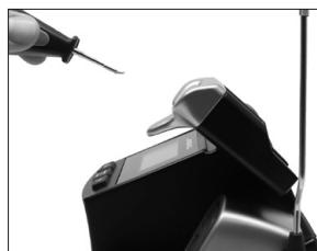
Nehmen Sie das Werkzeug aus der Ablage und die Werkzeugspitze wird auf die gewählte Temperatur aufgeheizt.
