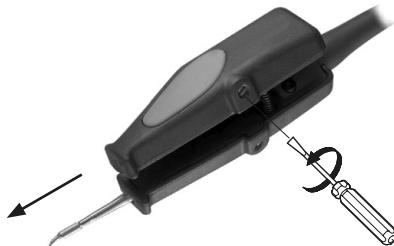
拧松螺丝并取出烙铁头。⚠ 使用平口钳以免烫伤。
