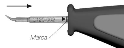
**Importante:** Inserte el cartucho hasta la marca para una correcta conexión.
