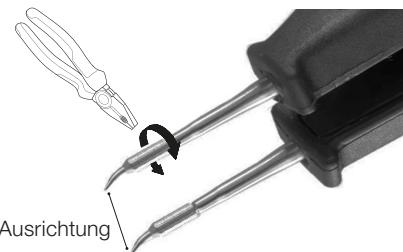
Ausrichten sie die Spitze der Kartusche. Benutzen Sie eine Flachzange, um die Spitze korrekt auszurichten. **⚠️** Sorgfältig darauf achten, dass die Kartuschen nicht überdreht wird.
